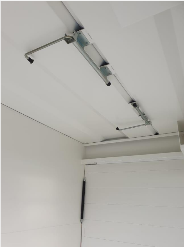
Uittrekbare steunen voor het ophouden van de containerdeksels
